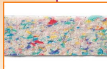
Wkład tradycyjny 120 kg/m 3 Traditional Core – compound foam 120 kg
